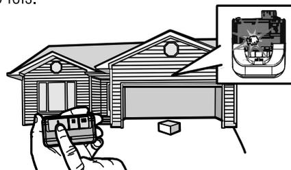
Si l'essai échoue encore, appeler un technicien formé en systèmes de porte. L'ouvre-porte de garage ne se fermera pas à l'aide d'une télécommande si le témoin DEL d'un des deux capteurs d'inversion est éteint (ce qui avertit que le détecteur est mal aligné ou obstrué).
